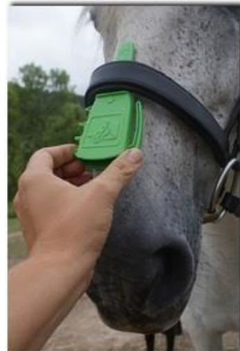
Kuva 1. a ja b. ISES'in turpahihnan kireysmittari. Mittarissa on asteikko myös kuolaimen paksuuden mittaamiseen.
